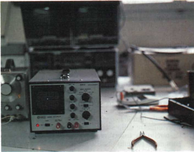
Fig. 4 - "Spot" centrato sul tubo, che rimane fisso, avendo neutralizzato la scansione orizzontale. Moltissimi oscilloscopi, in queste condizioni, riportano la "bruciatura" degli ossidi del tubo. Lo strumento NYCE ha una eccellente resistenza ai danni, anche per questa situazione quanto mai anomala. E comunque sconsigliabile mantenerlo a lungo in condizioni del genere.
